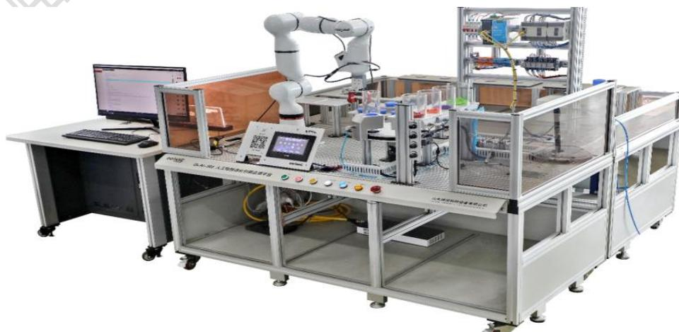
智能机器人技术应用竞赛平台，硬件部分包含协作机器人、PLC、电动手爪、计算机视觉检测单元、机器视觉检测单元、AGV 运载单元、工作站、药库模型、病房模型以及人机交互系统等部分组成；竞赛设备涉及 Python 编程技术、人工智能基础理论与技术、深度学习相关算法的基础知识及主流软硬件平台的使用、人工智能深度学习环境的搭建和配置、模型训练、计算机视觉检测技术、机器视觉技术、智能交互技术、协作机器人技术、PLC 技术等。
