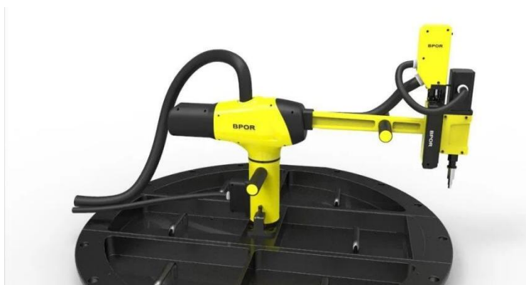
图 1. 核反应堆蒸汽发生器堵板操作机器人
