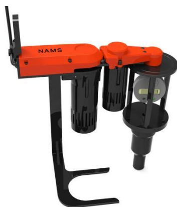
图 2. 核电环境整体螺栓拉伸机器人拉伸量测量装置
