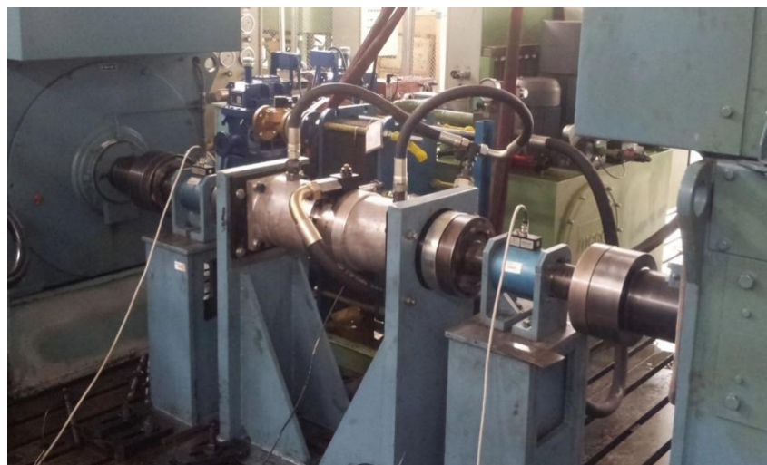
图 2. 背对背 285 排量泵马达试验
