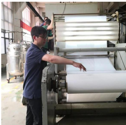
图 2. 间位芳纶工业废水分离膜
