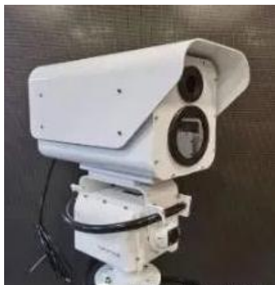
图 1. 宽波段气体泄漏红外成像检测系统产品样机
