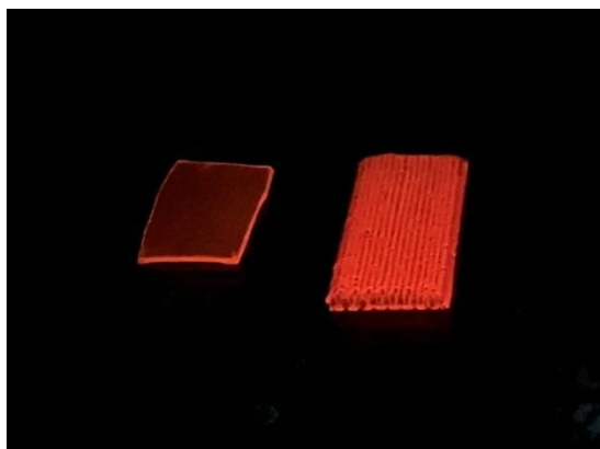
图 2. 普通块体与具有微结构器件的荧光图片对比
