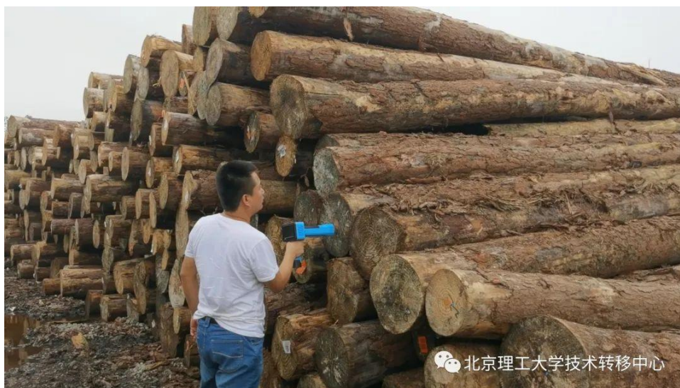
图 1. 第三代木材智能检尺系统在某地海关现场测试
