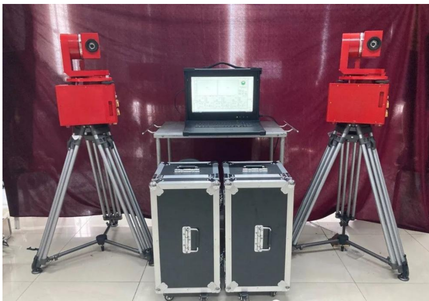
图 2. 云台变焦跟踪拍摄运动采集分析系统样机（双机位）
