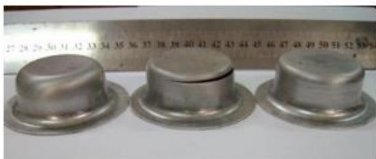
减小拉深件底部圆角
